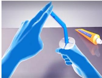
*Figura 8: aplicação de lubrificante.*
